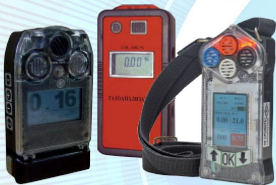
Для мониторинга аэрогазовой обстановки и передачи данных о составе окружающего воздуха на АРМ диспетчера, сотрудники используют индивидуальные газоанализаторы, оснащённые абонентскими модулями МА-45 (МА-48)
